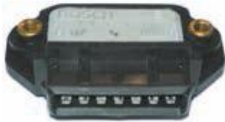
Figura 1.42. Bloc electrònic d'una encesa transistoritzada sense contactes.
