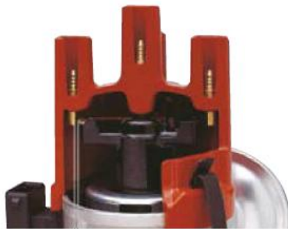
Figura 1.48. Distància disruptiva en el rotor.
