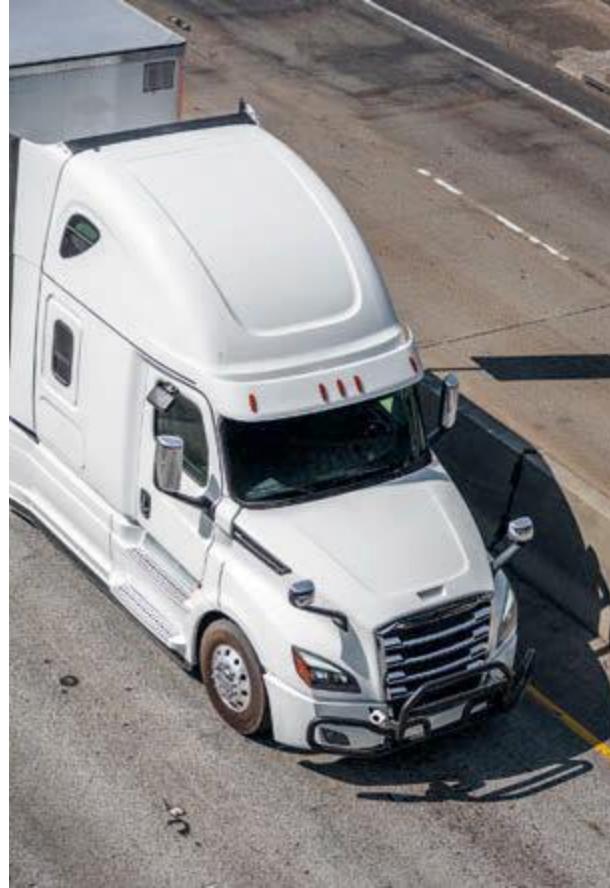
Figura 1.6. Cabeza tractora con diseño aerodinámico.
