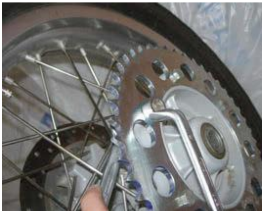
Figura 1.41. Montaje de la corona nueva.
