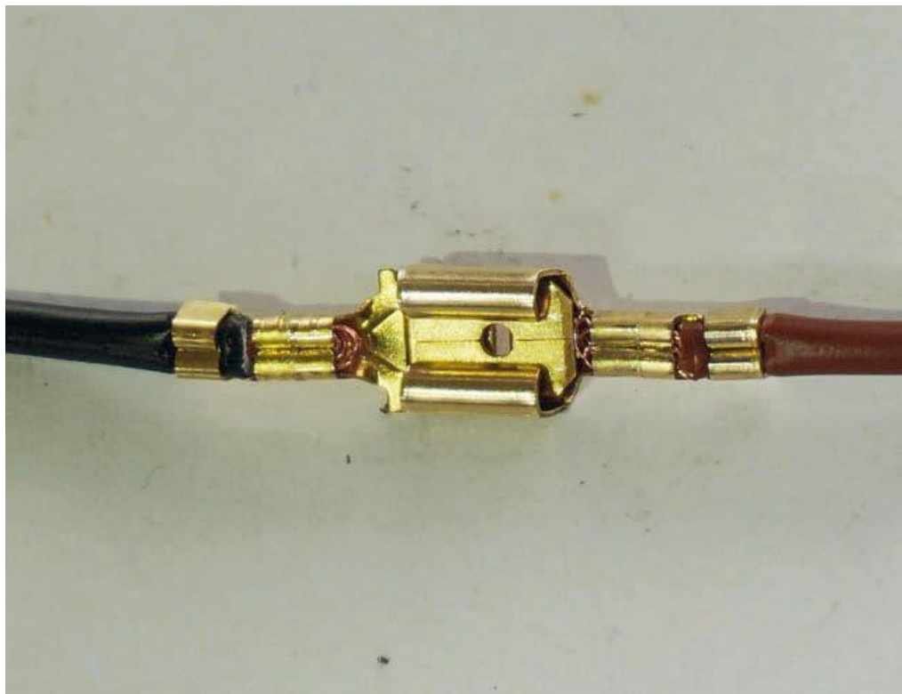
Figura 1.47. Terminales faston engatillados.
