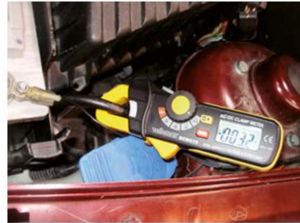
Figura 1.27. Medición de la intensidad en amperios.
