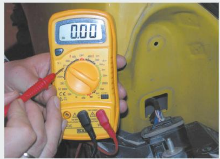
Figura 1.64. Seleccionar la escala adecuada.
