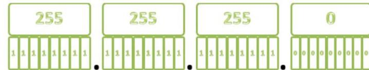
Al hacer una operación AND bit a bit entre la dirección IP y la máscara de red, obtenemos la dirección de red, con la que podemos obtener:
