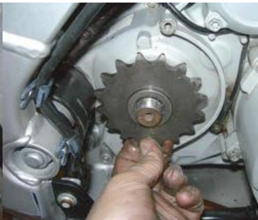
Figura 1.42. Muntatge del pinyó nou.
