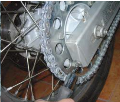
Figura 1.45. Centrament de la roda i tensament de la cadena.
