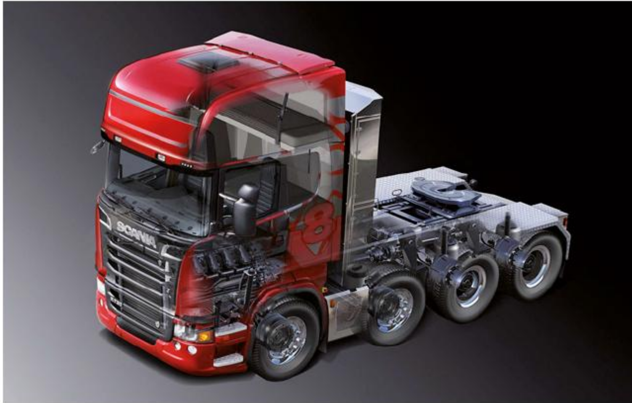
Figura 1.21. Cadena cinemàtica d'una transmissió 8x4.
