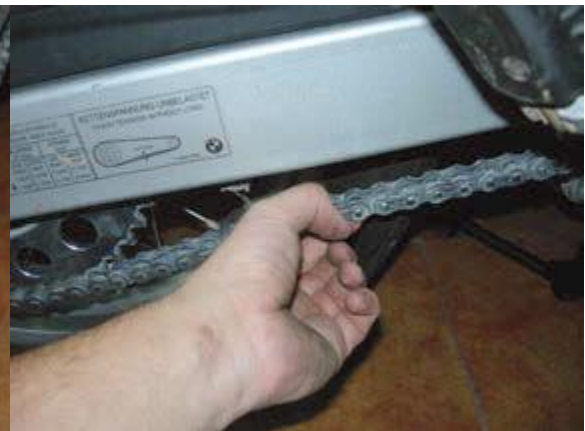
Figura 1.46. Comprovació de la tensió de la cadena.
