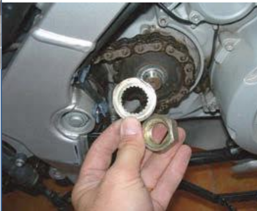
Figura 1.38. Extracció de la femella i de la xapa de retenció.
