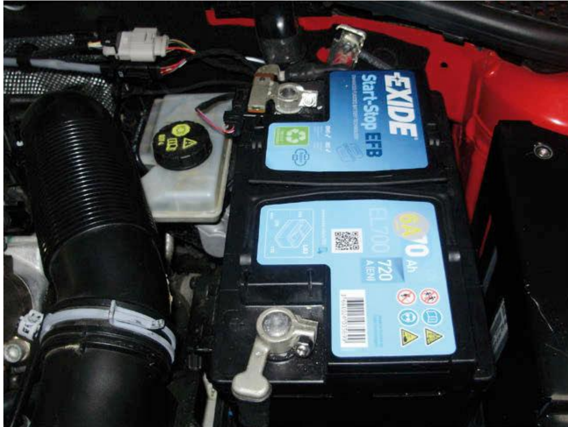
Figura 1.2. Bateria de 12 V.
