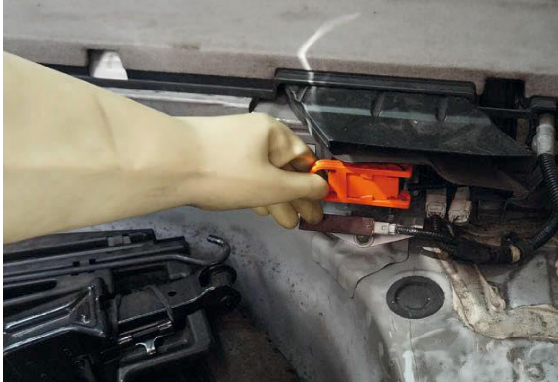
Figura 1.62. Desconnectador d'alta tensió i guant protector d'alta tensió.
